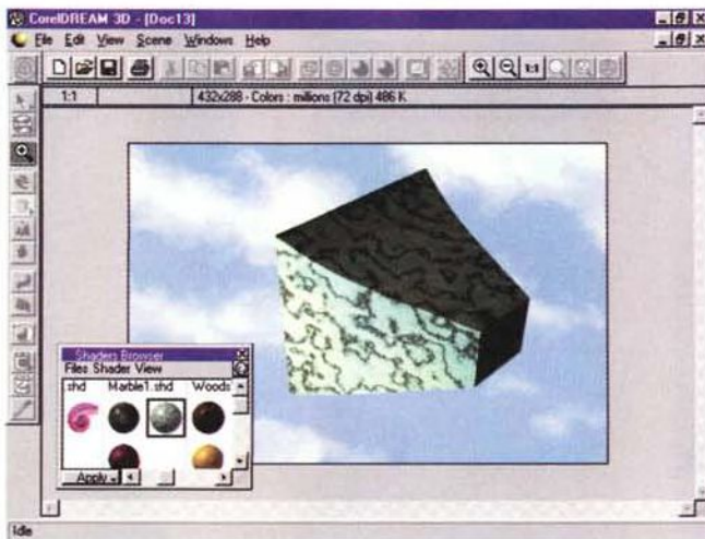
Figura 7 - CoreIDREAM 3D - Caratteristiche di un Punto Luce. Esistono la luce d'ambiente, per la quale vanno definite varie caratteristiche, e le altre luci da piazzare nella scena per illuminarla. Una luce ha una serie di caratteristiche geometriche impostabili direttamente nella vista Prospettiva (posizione, orientamento, ecc.) nella quale appare come qualsiasi altro elemento presente nella scena. Ha poi una serie di caratteristiche qualitative, impostabili in questa ricca Box in cui si sceglie colore, ampiezza del cono, tipo di sfumatura, ecc.
